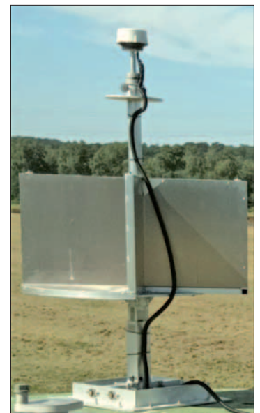
Abbildung 15: Doppel-CR mit Kunststoffhauben (links; © TRE ALTAMIRA) und Multisensorstation (rechts; © RAG, ALLSAT).
